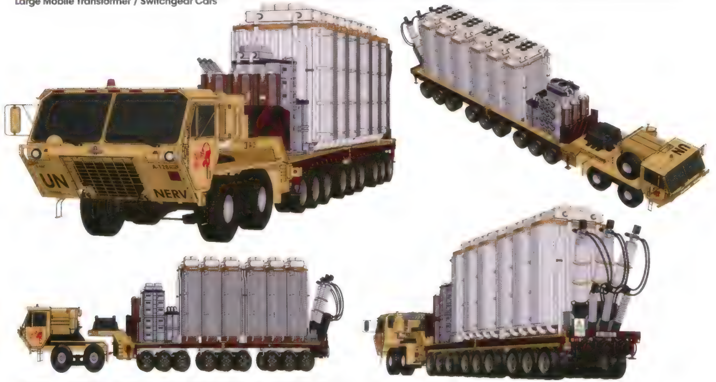
大型移動変圧及び開閉器車・車載型 275kV 超高压通常変圧器 (開閉装置、冷却装置等一体型) 3DCG モデル
